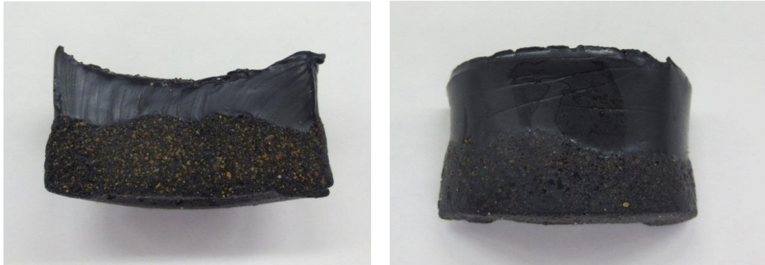
図-2 NOH2O ポリマーグラウトが砂に浸透硬化した状態
