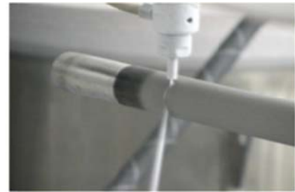
SUS 配管の切断例
