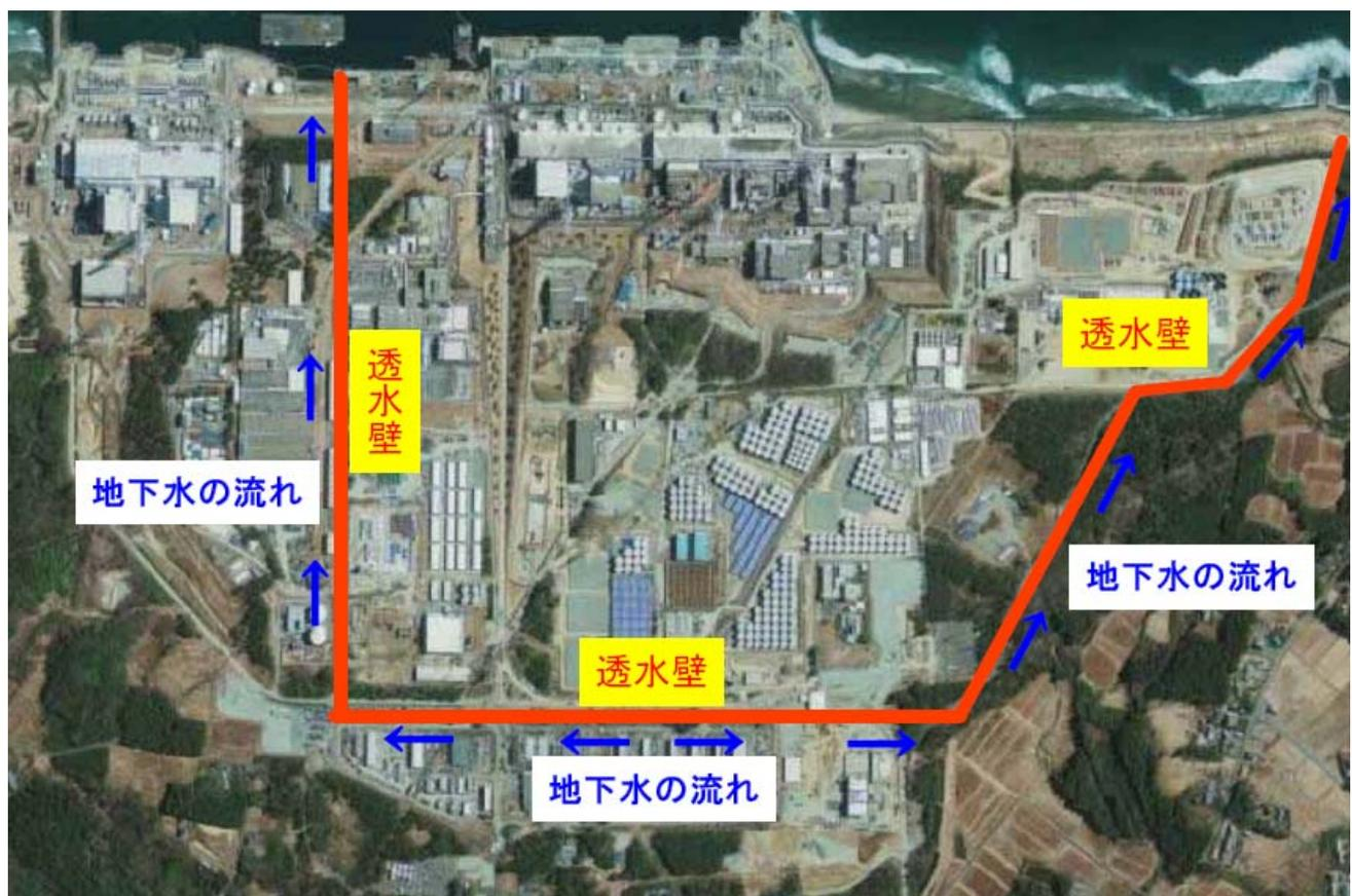
原子炉建屋から十分離れた汚染水貯蔵タンクの西側から 1F1 号機～4 号機までのエリアをコの字に取り囲む様に透水層を構築すれば、地下水を揚水したりせずに、地下水をそのままの状態ですぐ別の安全な場所（海）に導けるために、地下水は原子炉建屋に流入せず、汚染水の発生を抑制することが可能となります。一度透水層を構築すれば、地下水は、透水層内の水位勾配に従って下流域に流下するため、構築後は他のエネルギーを投下せずにメンテナンスフリーで運用が可能です。しかし、万が一のことを考えて、最下流域の端末部分にはゼオライト等の天然の吸着材を使用し、流入した放射性物質を吸着するシステムとします。
