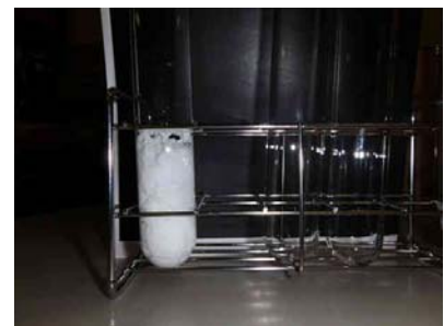
図3 強化材 10ml 添加後ゲル化 ゲルが約 40ml 生成した。
