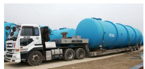
120t 地上設置型タンクの運搬
