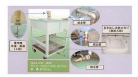
使用している凝集沈殿設備の解説図を右に示す。
