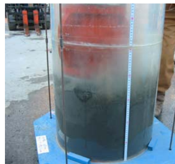
写真 アクアソイルF水中打設実験
