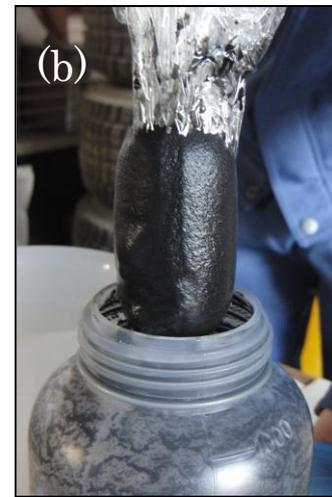
資料2. 福島県二本松市での試験. (a)除染試験の様子, (b)吸着剤回収の様子. 円筒状の磁石の周りに吸着剤等が大量に付着している.
