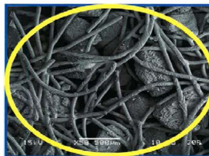
図-2 エアレイド不織布の電子顕微鏡写真
