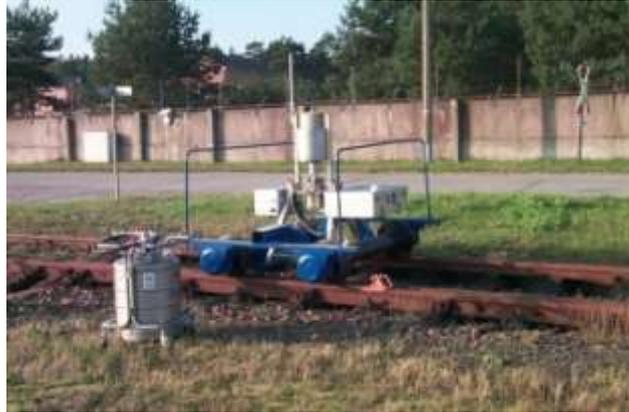
図 16 地表面の迅速な放射性核種及び濃度分析方法 (Ge 半導体法)
