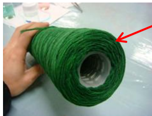
図 7-1 セシウム除去用 ワインドフィルター
