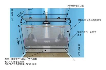
図 溶接タンクの接続管部の漏水対策概念図
