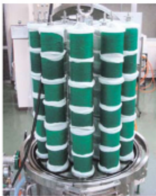
ナイロン繊維を反応させ て吸着材に仕上げる
