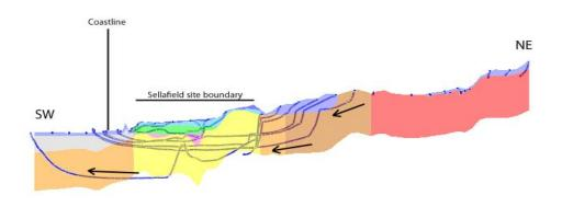
Sellafield 汚染地および地下水管理プロジェクトでの業務以来、汚染地下水のプルームが伸びる割合を決定するため、施設からの放射性核種の仮説的な漏洩をモデル化した。Sellafield Ltd が、地下水中の放射性核種の挙動を制御するのに、どのような対策を展開する必要があるかにおける時間枠を把握するのに重要である。
