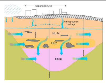
概念モデルが、ConnectFlow の中で数値モデルを開発するのに使用された。Sellafield 汚染地プロジェクトに対しては、 地域からと Sellafield サイトからの地下水標高データを使用して ConnectFlow モデルを校正した。隔離領域 (下図参照)を通しての水の挙動を把握するのに、このモデル (参照モデル)を用いた。それとは別に、GoldSim コンピュータ・プログラムを用いてサイトでの主要な汚染源のモデルを開発した;また、汚染源からの地下水への放射性核種の時間依存の解放を記述する、これらの GoldSim モデルを使用した。その上で、地下水中の放射性核種の伝播を計算する ConnectFlow を使用した。また、トリチウム、テクニシウム 99 およびストロンチウム 90 の振る舞いを検討した。これらの放射性核種は、地下水プルームの重要な成分である。代替となる概念モデルとパラメタの不確定性の結果が調査できる一連の変形したモデルも開発した。
