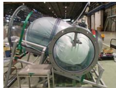
図4 PCV下部止水用閉止補助材試験状況
