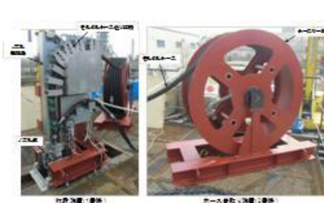
図5 PCV上部止水用試験装置
