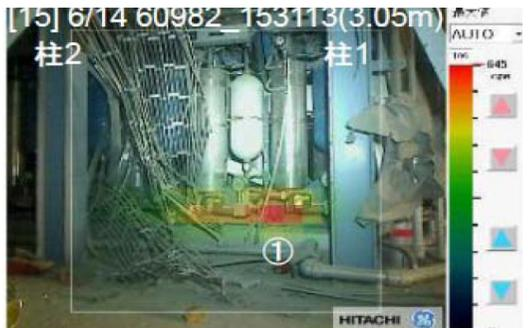
放射線源調査結果 (ガンマカメラ) の例 (3号機南側HCU)
