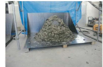
D/W外側狭隘部止水材要素試験
