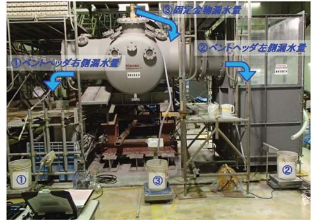
写真8-1 漏水量計測項目(400kPa耐水圧)
