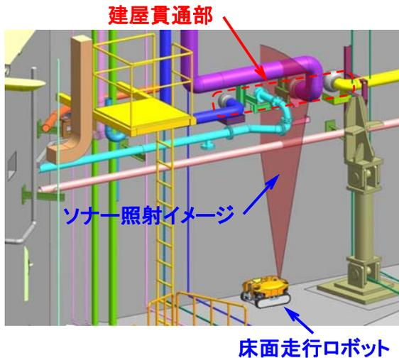
床面走行ロボット(超音波ソナー)による
