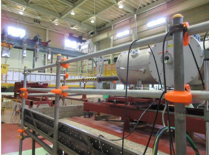
調査装置、監視用カメラ、エン트리回収に用いる治具等を事前にセットし、シールボックス外から操作
