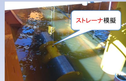
工場試験(ストレーナ埋設前)
