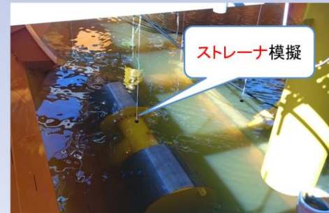
工場試験(ストレーナ埋設前)
