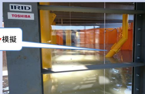
工場試験(コンクリート打設中)
