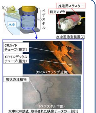
図2 3号機ペDESTAL内調査結果
