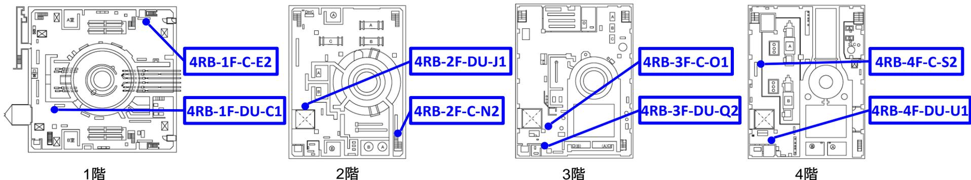
4号機原子炉建屋からの試料採取場所
