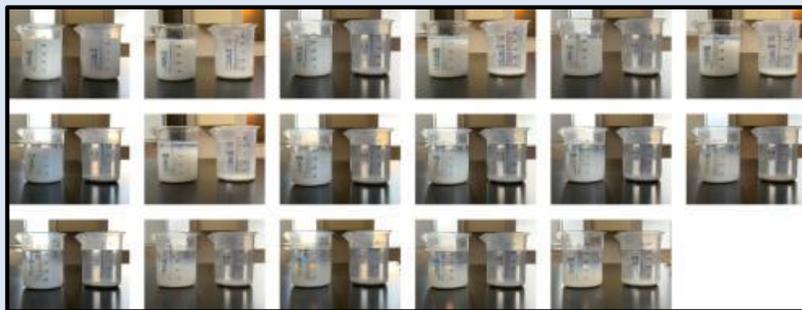
沈降率測定試験の様子：異なる水質条件（右試料；pH = 6、左試料；pH = 7）における $ZrO_2$ 微粒子沈降の時間変化（左上写真；測定開始時の試料、右下写真；280時間後の試料）
