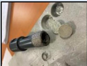
上記切断装置の性能試験結果 (ダイヤモンド被覆型ビットによる  $ZrO_2$  ブロックの切断試験)
