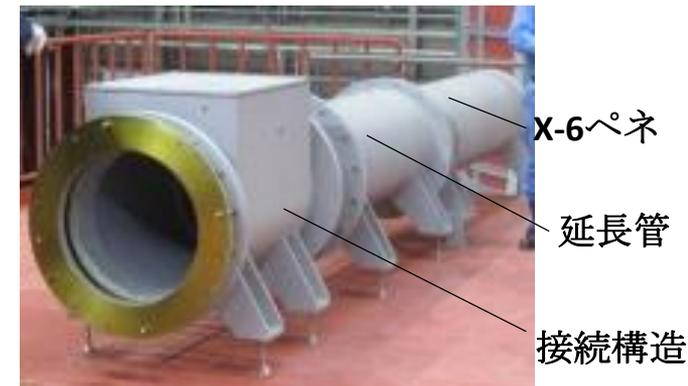
X-6ペネ (接続構造+延長管接続後) の様子
