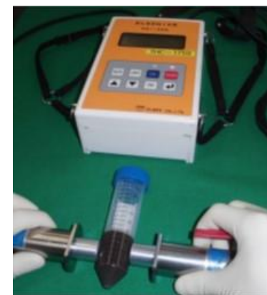
図3 遠沈管を用いた超音波測定の様子
