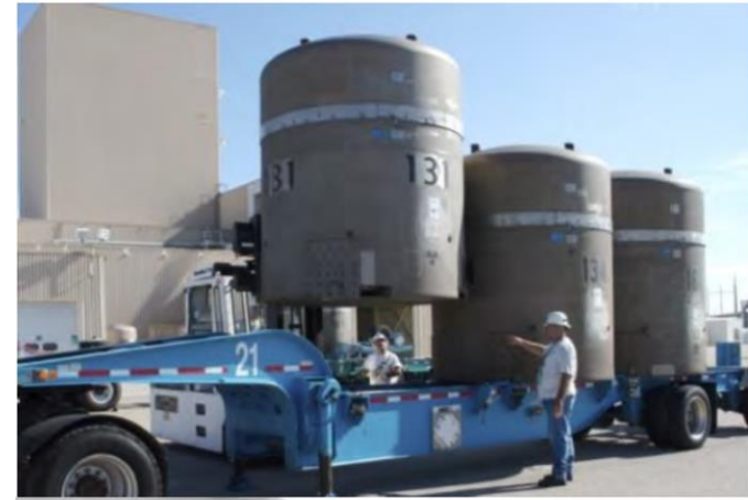
図1 一般的な高線量廃棄物の移送容器の例 (TRUPACT-II)
