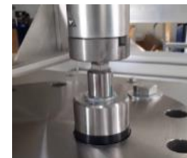
閉止栓取付の様子
