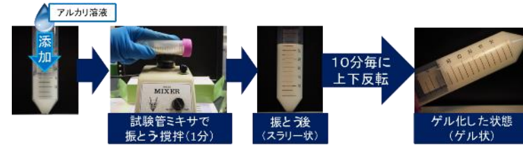
図1 AAMのゲル化時間の評価方法
