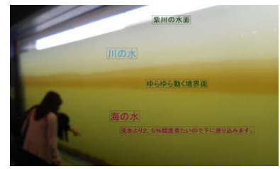
図2 河川水と海水が層状構造をなす塩水くさびの例 小倉城と紫川の塩水くさび, http://karurakarura.seesaa.net/article/420313034.html
