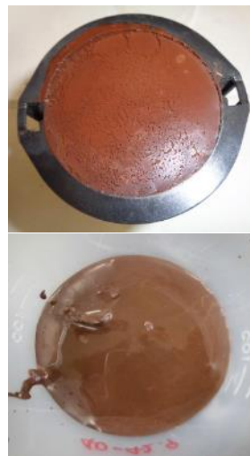
図2 小型カップ(下: φ5.8×8.5cm)と φ5×10cm容器でのブリーディング確認
