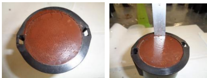
図3 固化体上面のブリーディングの状態(一例) (水/固体比41mass%、廃棄物充填率35mass%)
