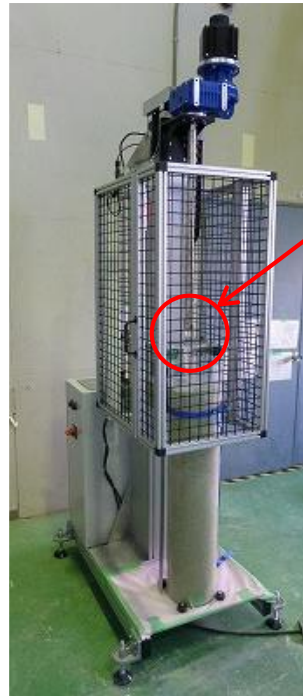
図2-1 採取予備試験装置
