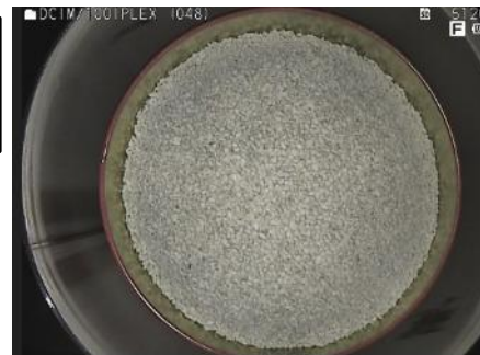
写真③ ゼオライトの状況 (内視鏡:直視遠点)
