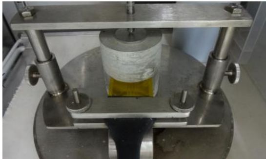
図1 ホットディスク法による測定
