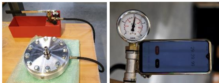
(a) 耐圧予備試験装置 (b) 圧力の時間変化の確認
