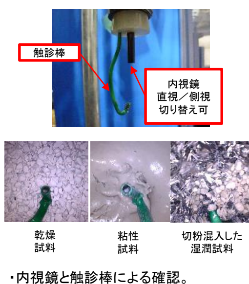
図2 吸着塔内部確認
