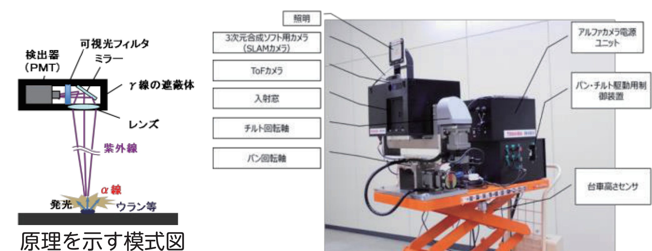
図1 \alpha 汚染検出器の原理と装置の外観
