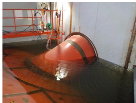
左図：内側水位，右図：外側床面 外周への漏えいは確認されなかった
