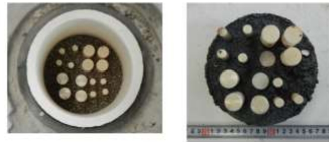
(1) 加熱前(材料をるつぽに装填した状態)
