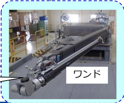
試験的取り出し装置はワンド先端に設置
