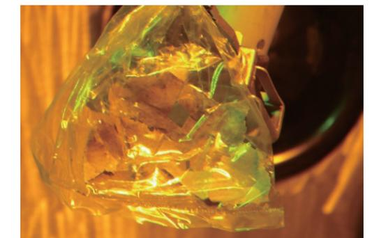
▲ 2号機原子炉建屋5階で採取した分析対象の養生シート
