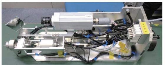
▲極細線金ブラシ方式 試作機
