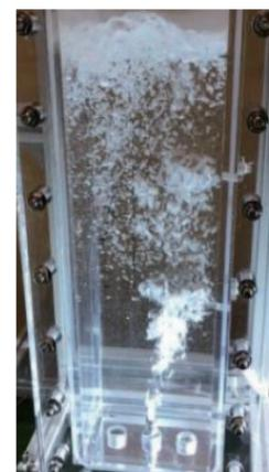
▲気液界面における微粒子移行試験(図14)
