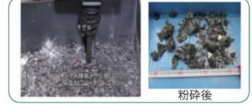
▲チゼル—デブリ微細化および亀裂進展による水との混合
