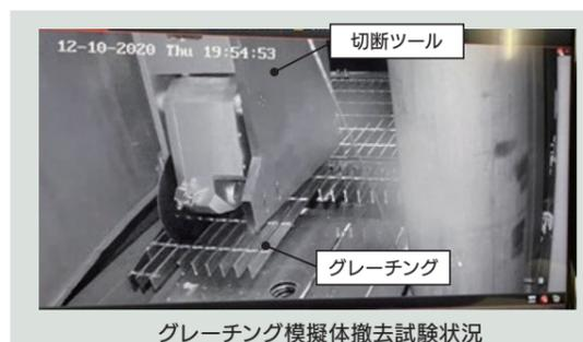
グレーチング模擬体撤去試験状況
