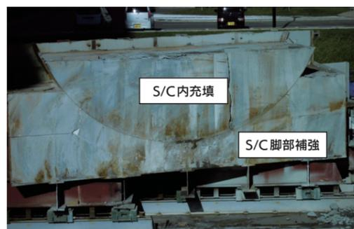
▲ 1/1スケール充填状況試験結果 (図7)
