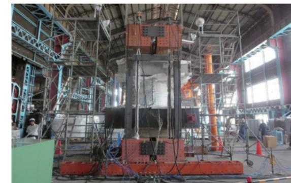
▲RPVペDESTALの耐力評価試験(縮小模型試験体)(図4)
