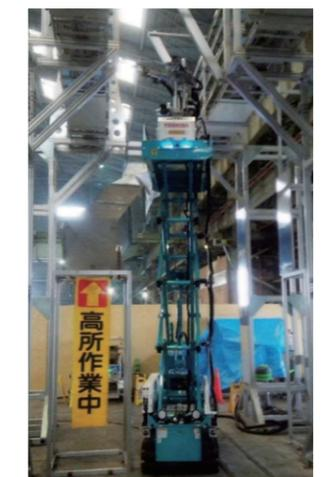
▲高所用ドライアイスプラスト除染装置(図6)
