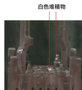
◀4号機使用済燃料の外観観察結果(瓦礫が混入した燃料の上部タイプレート部)(図2)
