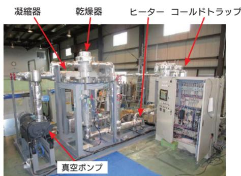
▲実規模乾燥試験装置 外観(図9)
