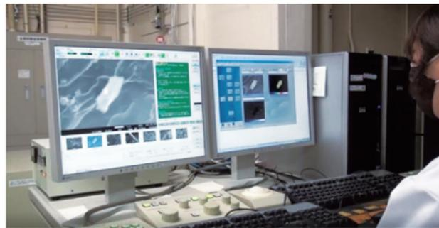
▲炉内で採取された付着物試料の SEM 分析の様子 (図16)
