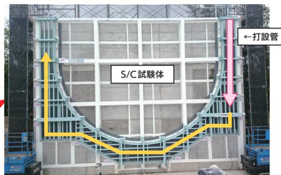
▲ S/C 脚部打ち上がり性状確認試験 (1/1スケール: 2,3号機を模擬) (図3)
