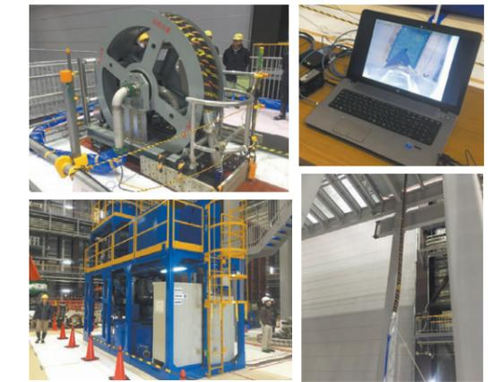
▲左上：打設装置、右上：打設装置の先端監視カメラ映像、左下：ミキサー、右下：打設装置のノズル効果状況 (写真2)
