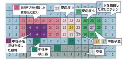
▲KUCAでの燃料デブリを模擬した試験体系例(デブリ分布の不均一性と中性子吸収材を模擬した炉心)
