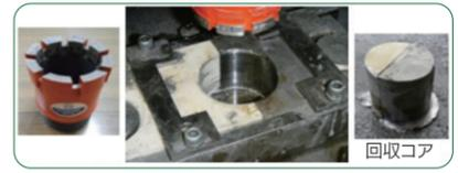
▲コアボーリング—コア抜きした穴への水とデブリ細粉の蓄積
