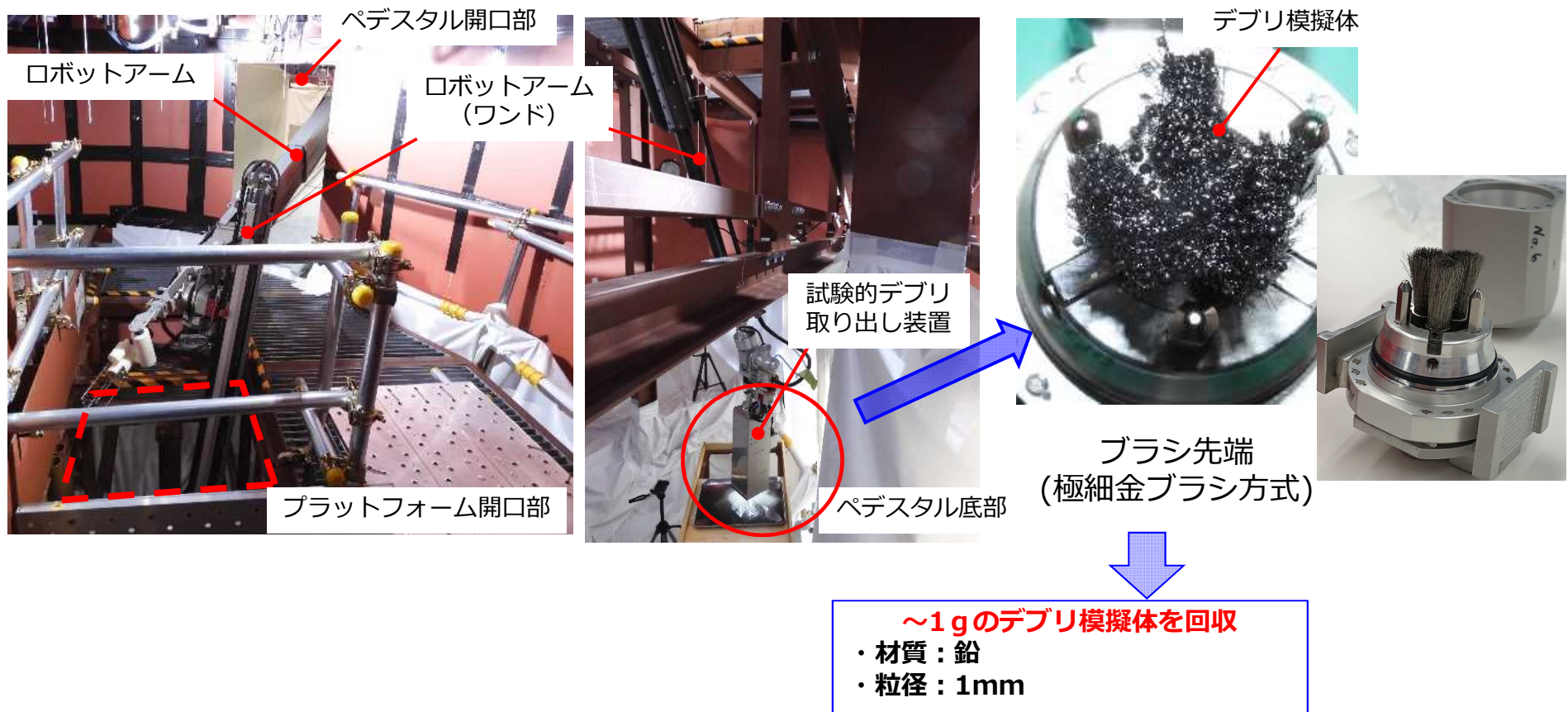
PCV内部へのアクセス性確認 (デブリ回収) 試験の状況
