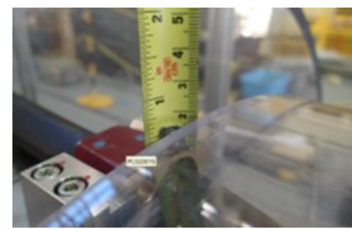
隙間計測 最小クリアランス (X-6ペネ入口の上側)
