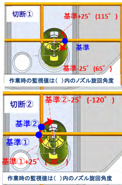
図4.1.1(3)(iii)-2 手摺中棧切断計画図
