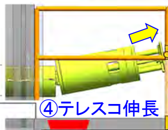
図4.1.1(3)(iii)-1 手摺中棧切断のAWJヘッド設定方法
