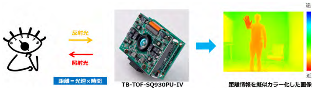
図34 TOFデプスカメラの測定原理
