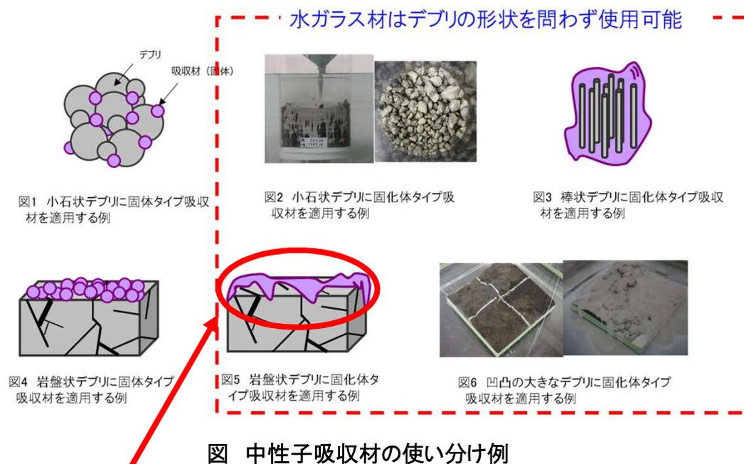
燃料デブリ表面を吸収材が覆っているような場合、**燃料デブリの乾燥を阻害する**懸念が指摘されている。
