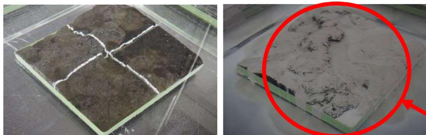
図 凹凸表面を水ガラス吸収材で覆った例
