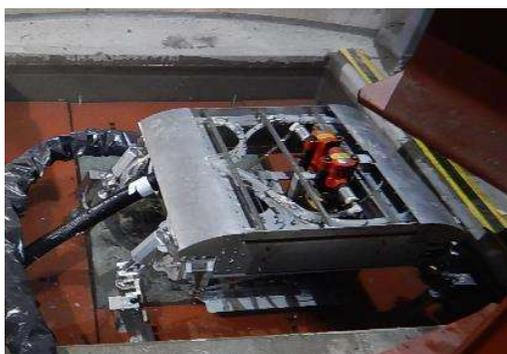
重量物運搬装置による破碎吸引装置の搭載および移動
