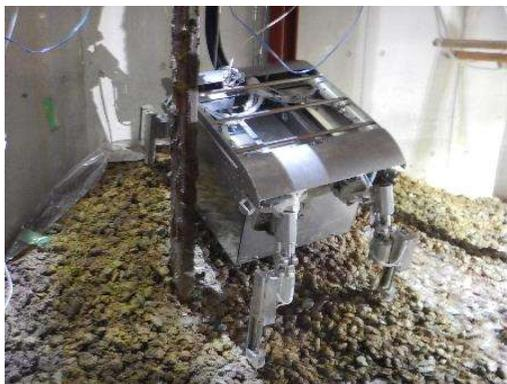
重量物運搬装置による中性子検出器ユニット(模擬体)の搭載および移動
