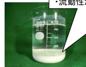
フィルタ廃液凝集沈降試験
