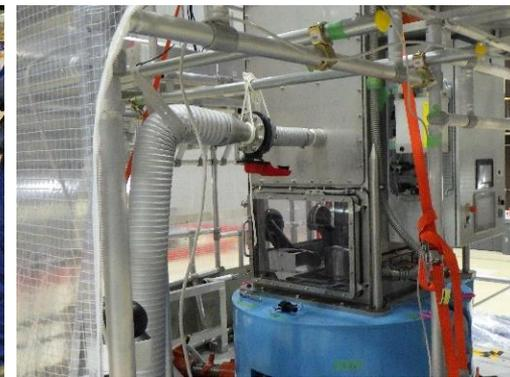
換気ユニットの換気風量確認
