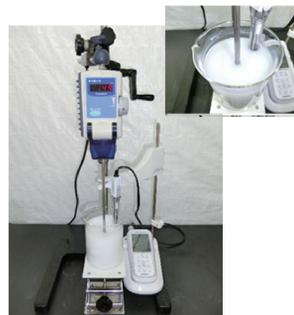
模擬RO濃縮水処理試験装置
