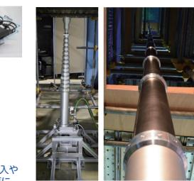
図3 14段テレスコパイプによる伸縮試験
