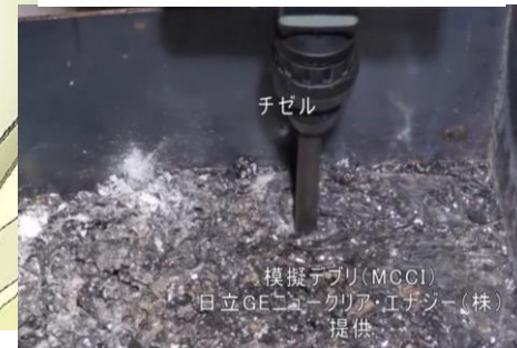
燃料デブリ切断技術の例 (チゼル)
