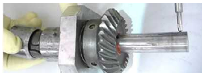
A側横軸の変形
