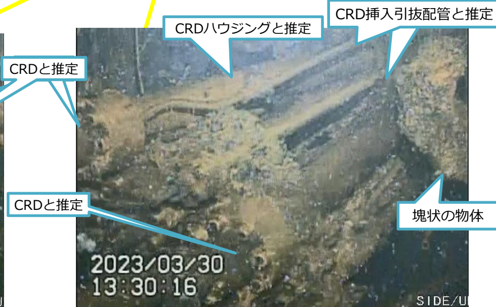
写真3. CRD関連と思われる構造物 (上部監視カメラで気中を撮影)
