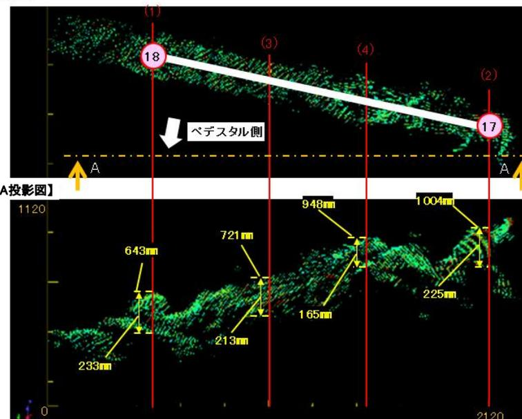
ROV-B堆積物高さ評価結果: 約0.64~1.00m
