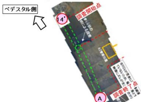
ROV-Bの点群とROV-Cの測定ラインの位置合わせ
