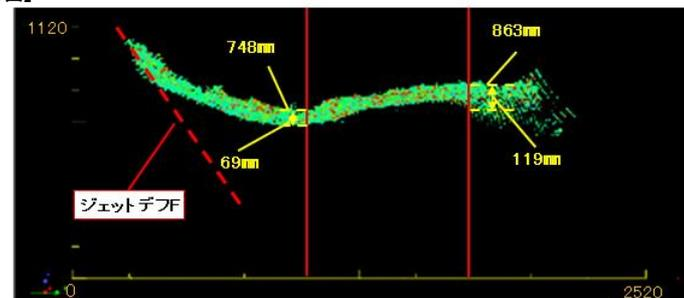
ROV-B堆積物高さ評価結果: 約0.75~0.86m
