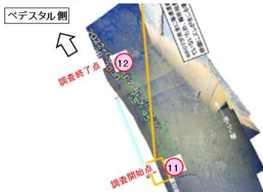
ROV-Bの点群とROV-Cの測定ラインの位置合わせ
