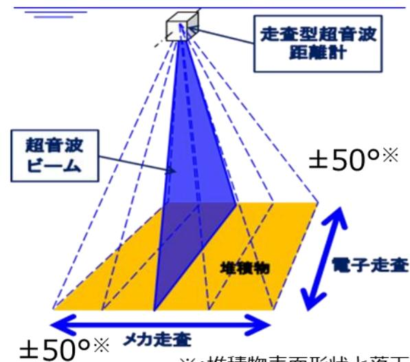
※:堆積物表面形状と落下物高さ測定が可能な入射角
