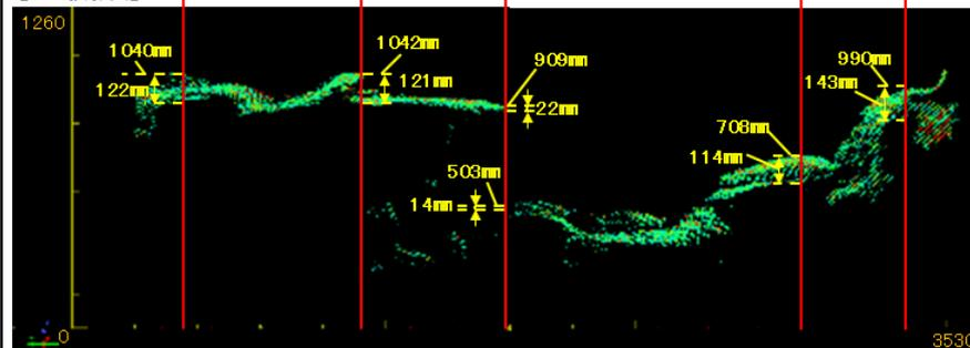
ROV-B堆積物高さ評価結果: 約0.50~1.04m
