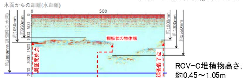
ROV-Bの点群とROV-Cの測定ラインの位置合わせ
