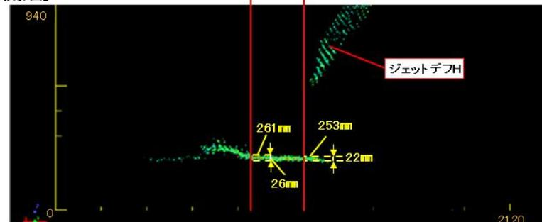
ROV-B堆積物高さ評価結果: 約0.25~0.26m
