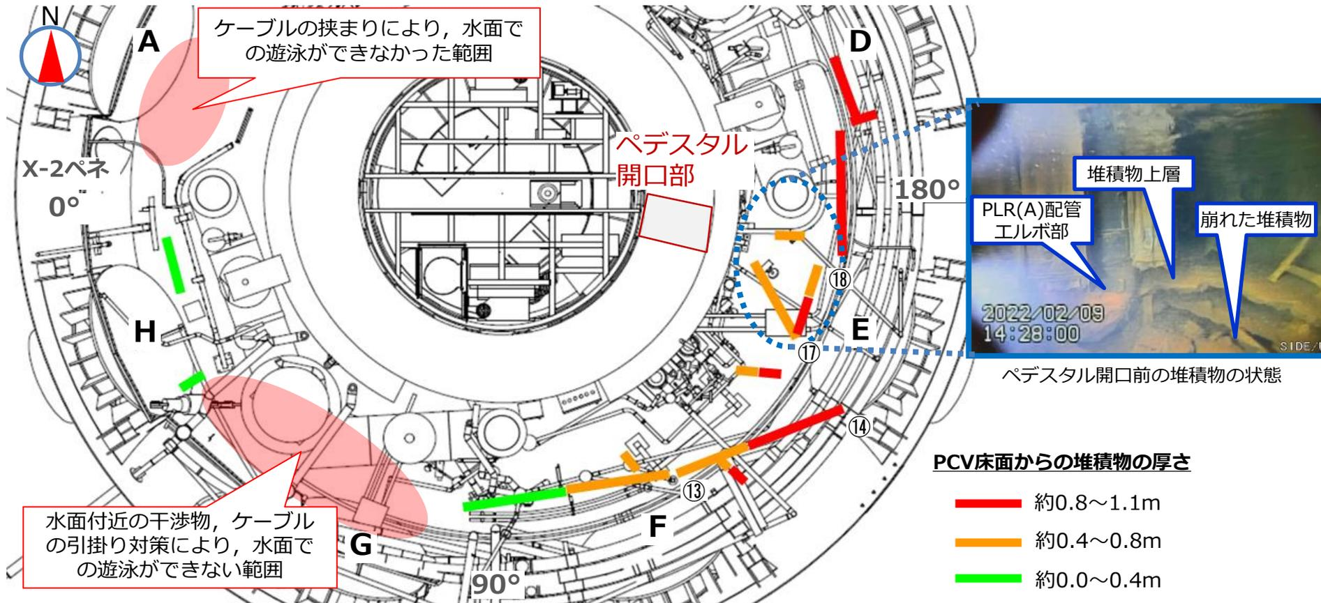
※PCV床面からの堆積物の高さは水位2.0mを基準として算出
