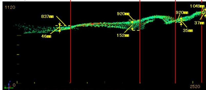
ROV-B堆積物高さ評価結果: 約0.84~1.05m
