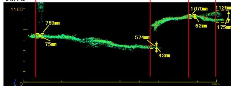
ROV-B堆積物高さ評価結果: 約0.57~1.13m
