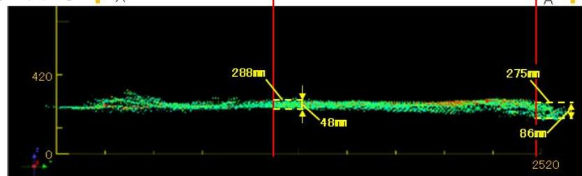
ROV-B堆積物高さ評価結果: 約0.28~0.29m
