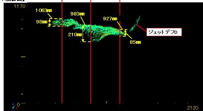
ROV-B堆積物高さ評価結果: 約0.93~1.06m
