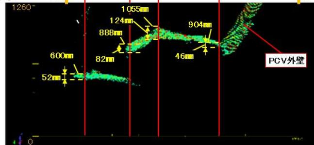
ROV-B堆積物高さ評価結果: 約0.60~1.06m
