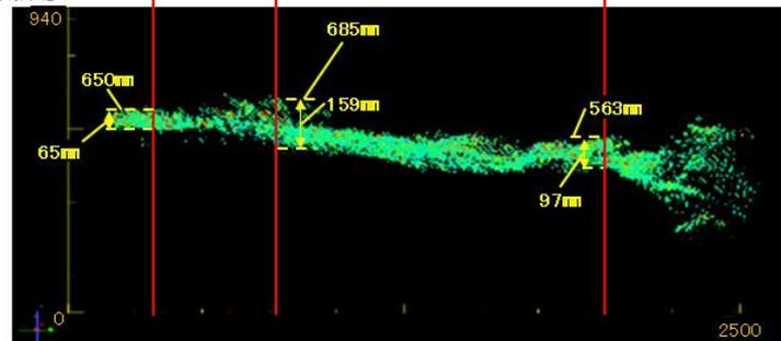
ROV-B堆積物高さ評価結果: 約0.56~0.69m
