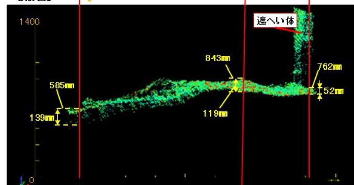
ROV-B堆積物高さ評価結果: 約0.59~0.84m
