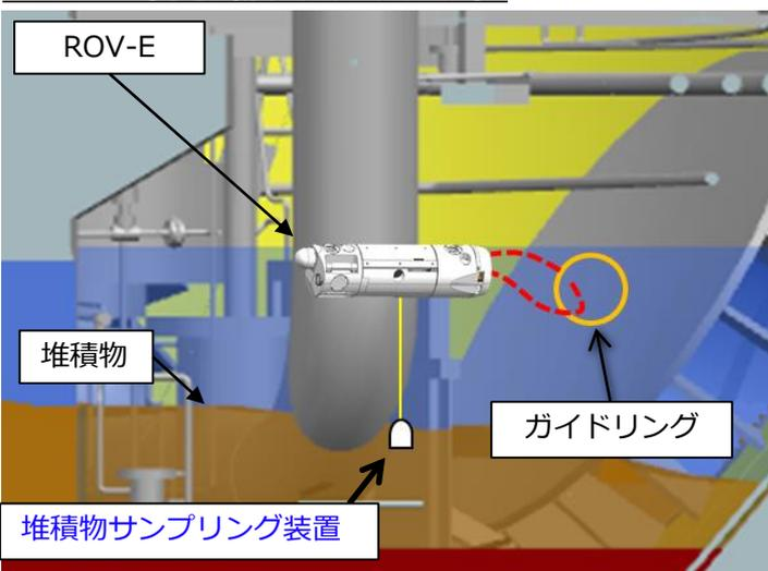
サンプリング装置を堆積物上に吊り降ろし吸引を実施
