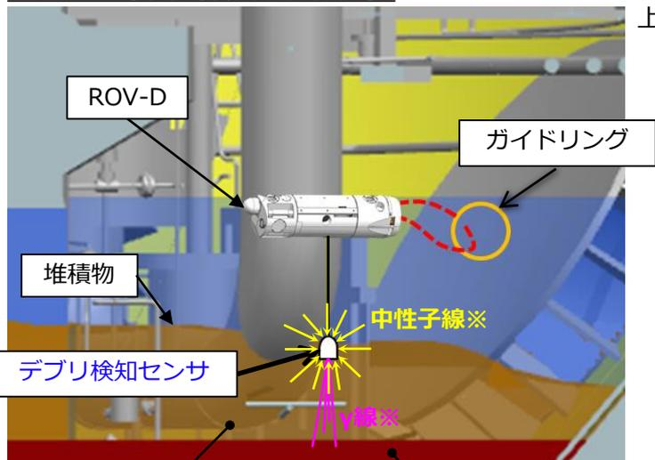
デブリ検知センサを堆積物上に吊り降ろし計測を実施
