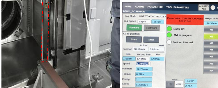
非常駆動ツール操作パネル (ダブルドア機構の制御プログラムを移植)
