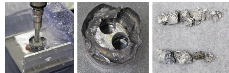
集光加熱試料のコア抜き試験の様子
