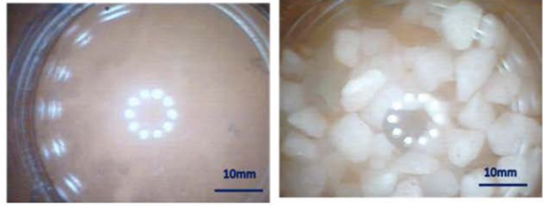
図4 堆積物除去前後の模擬デブリ(砂利)撮影例 (a) 堆積物除去前 (スラスト回転前) (b) 堆積物除去後 (スラスト回転後)
