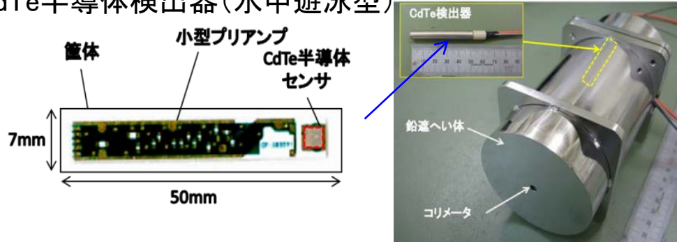
図1 小型CdTe半導体検出器(試作品)の外観
