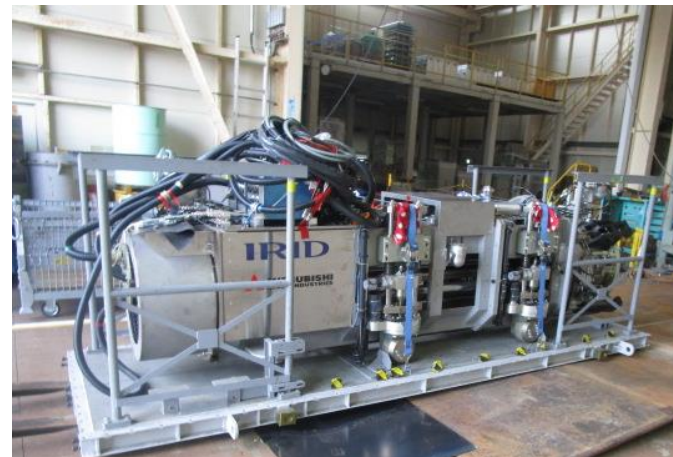
堆積物除去装置 (高圧水・AWJ) 外観
